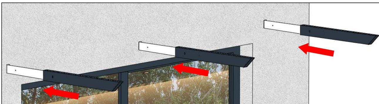
5. Visser les tubes alu sur chaque console. Le vissage s'effectue sur le côté des tubes alu avec les vis BHC M6x20 inox fournies.
