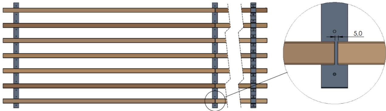
7. Placer les cavaliers en aluminium à leur emplacement, puis mettre en œuvre les vis BHC M5x10 inox fournies.
