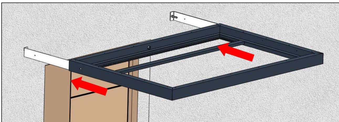
5. Visser la structure aux consoles. Le vissage s'effectue de chaque côté des tubes alu avec les vis BHC M6x20 inox fournies.
