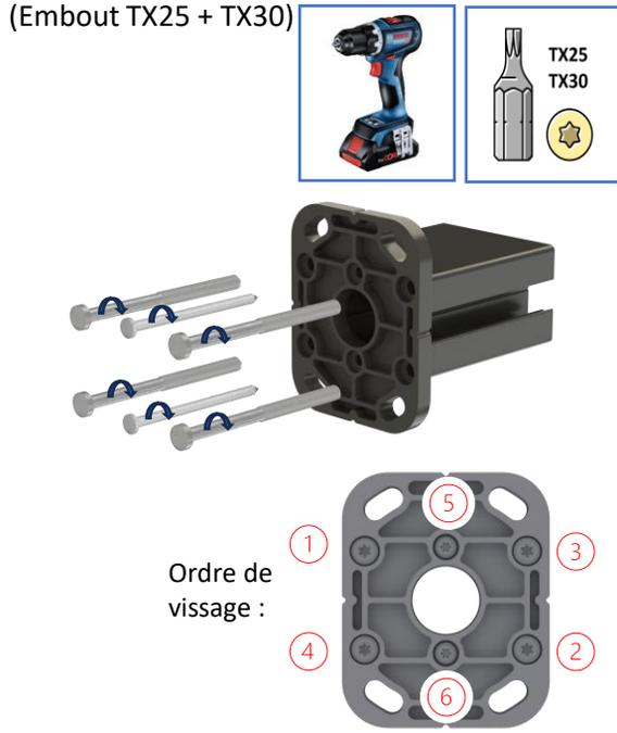
**Étape 3 : Assembler les poteaux d'angle (si nécessaire), à l'aide de vis autoperceuses (Ø4,8x19 fournies)(Embout TX25)**
