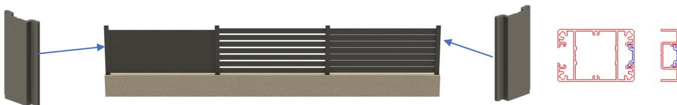
**Etape 8 : Insérer les bouchons sur les poteaux et demi-poteaux avec un maillet**
