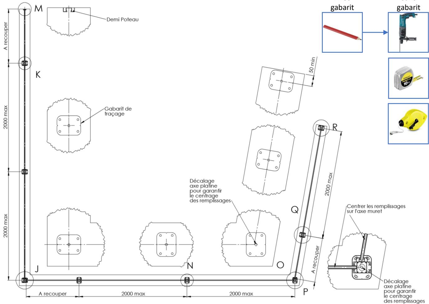
**Etape 5 : Fixation des poteaux pose sur platine**
