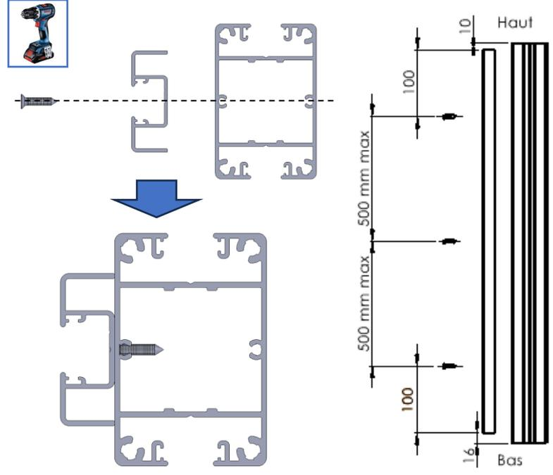
**Etape 4 : Tracer et percer le nombre de trous nécessaires à votre configuration (Fixation  $\varnothing 8$  mm)**
